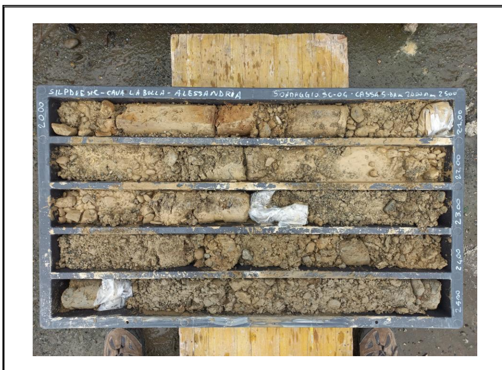
Foto 24: Sondaggio SC-04 - cassa 5 - da 20.00 m a 25.00 m.
