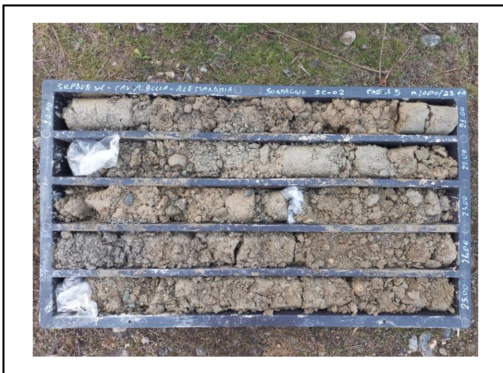
Foto 11: Sondaggio SC-02 - cassa 5 - da 20.00 m a 25.00 m.
