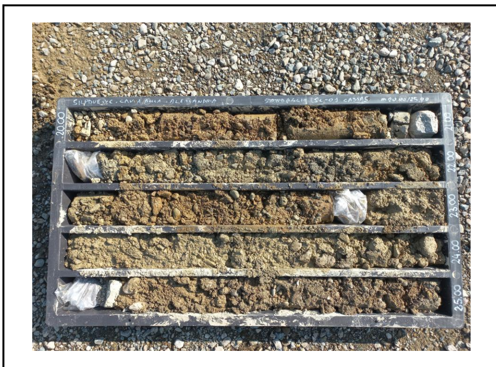
Foto 5: Sondaggio SC-01 - cassa 5 - da 20.00 m a 25.00 m.
