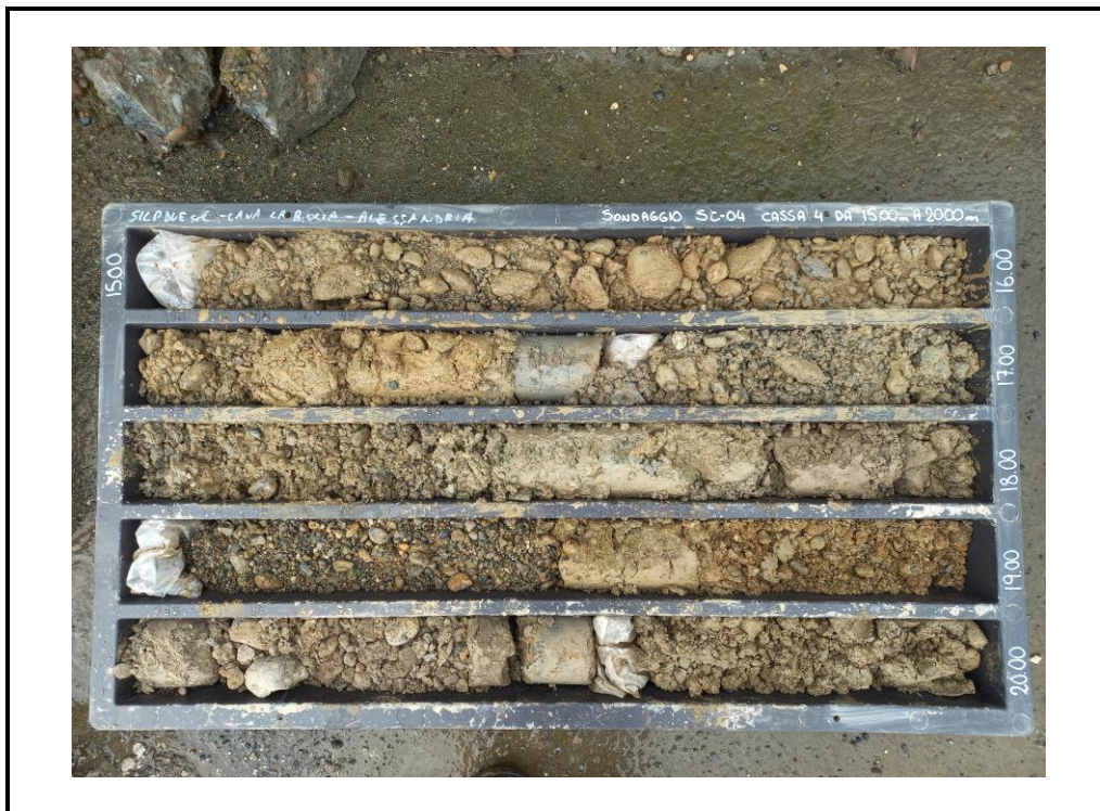
Foto 23: Sondaggio SC-04 - cassa 4 - da 15.00 m a 20.00 m.
