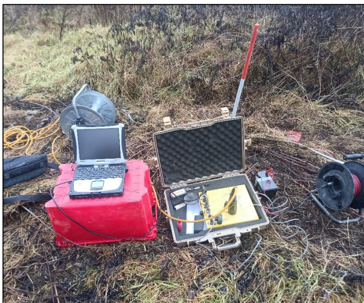
Figura 1: Strumentazione utilizzata – Sismografo Daq Link IV
