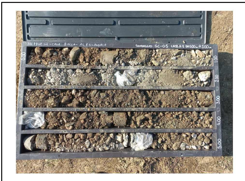
Foto 27: Sondaggio SC-05 - cassa 1 - da 0.00 m a 5.00 m.
