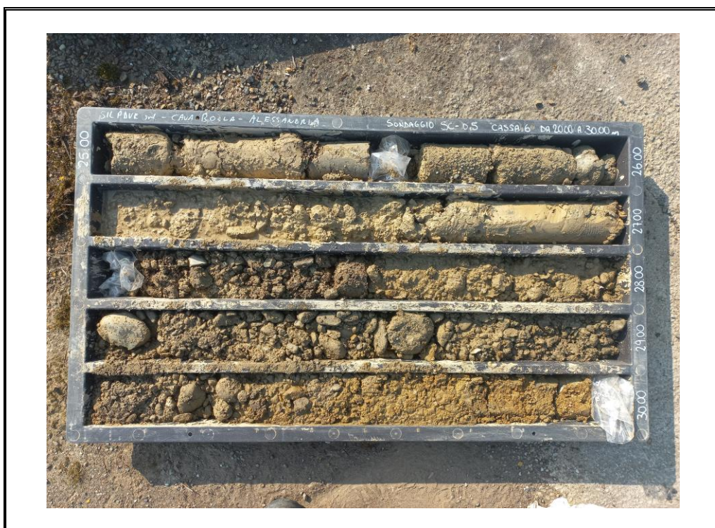
Foto 32: Sondaggio SC-05 - cassa 6 - da 25.00 m a 30.00 m.
