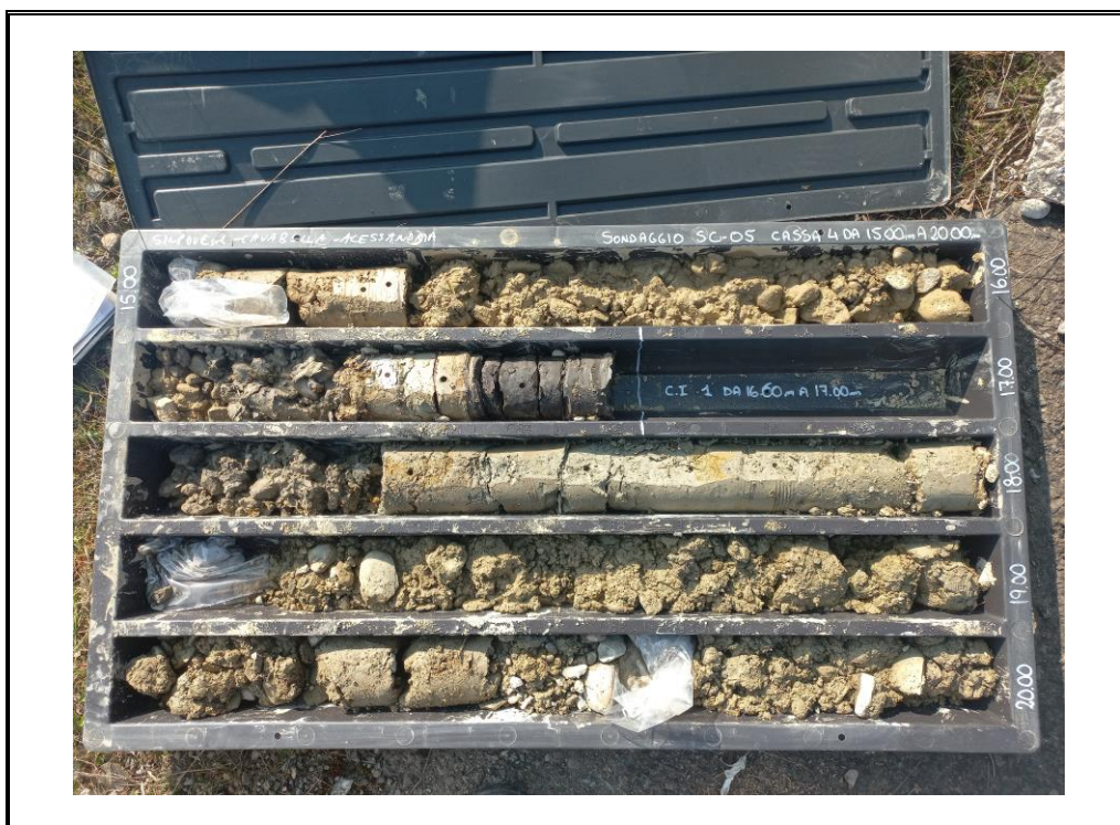
Foto 30: Sondaggio SC-05 - cassa 4 - da 15.00 m a 20.00 m.
