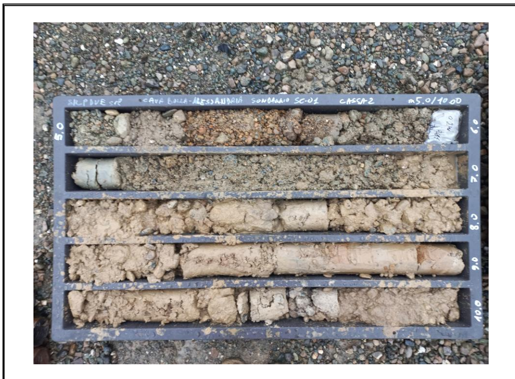
Foto 2: Sondaggio SC-01 - cassa 2 - da 5.00 m a 10.00 m.
