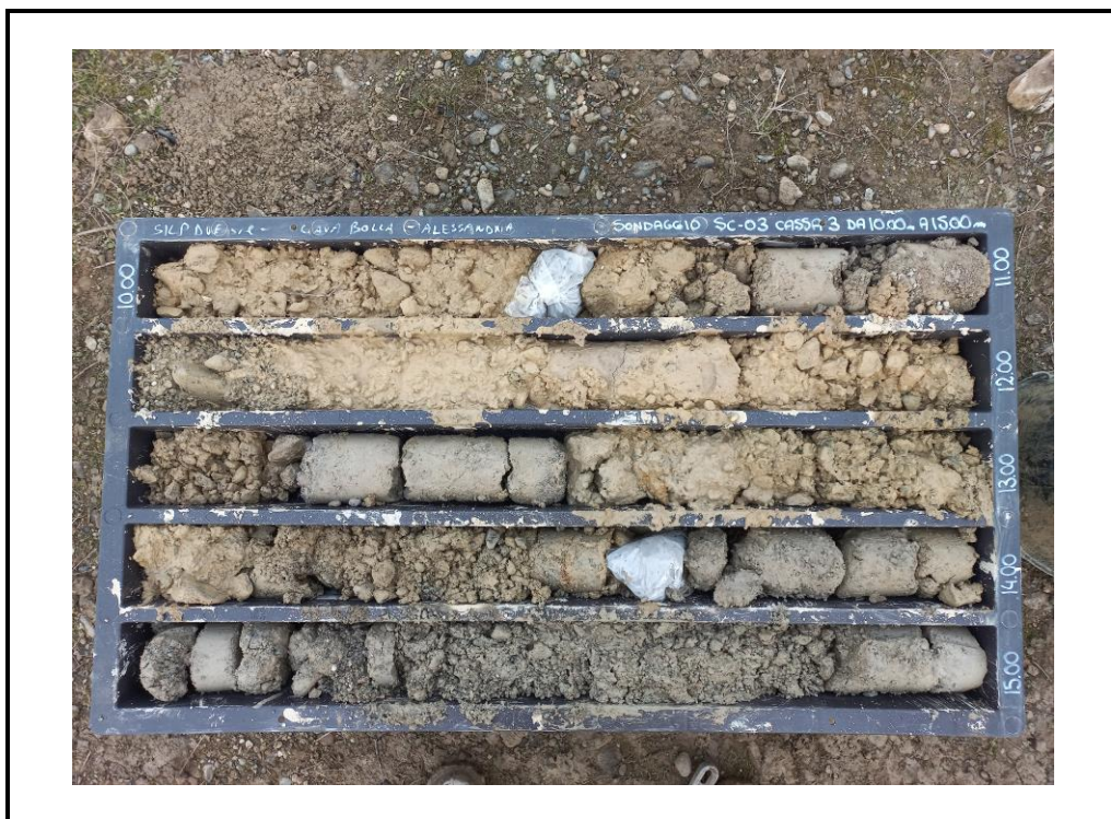
Foto 15: Sondaggio SC-03 - cassa 3 - da 10.00 m a 15.00 m.
