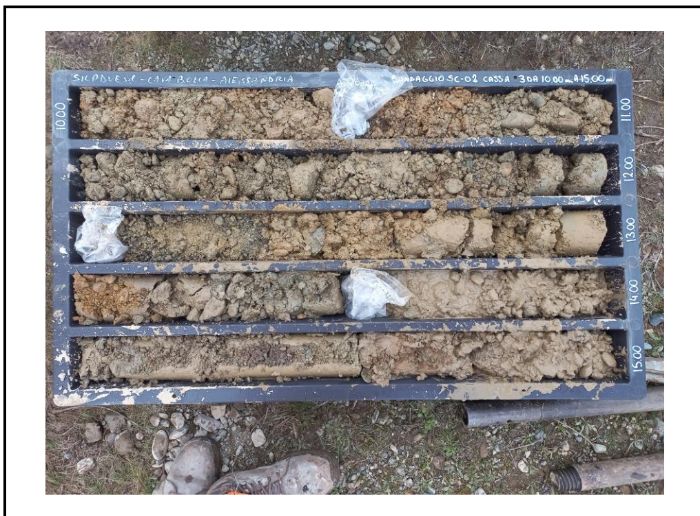
Foto 9: Sondaggio SC-02 - cassa 3 - da 10.00 m a 15.00 m.
